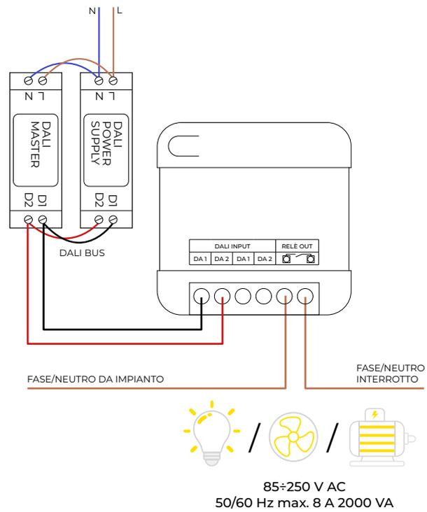
FIG. 1 - collegamento DALI2-1RELE
